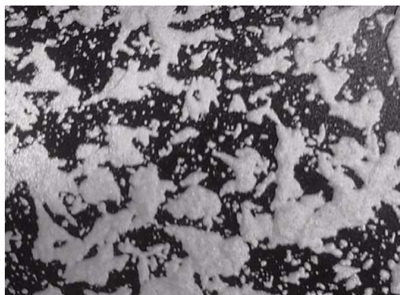
Obr. 7: Příklad rozmístění jednotlivých baretů, vzhled struktury VDZ
