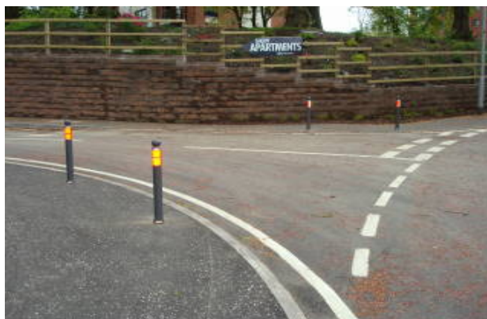
Obrázek 3 - Příklad umístění zvýrazňujících sloupků
