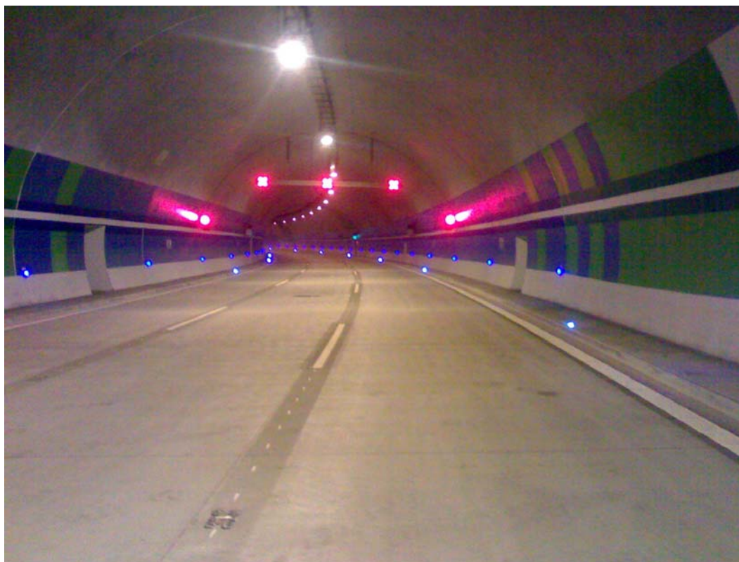
Obrázek 11 – Použití vodicích trvale svítících knoflíků v tunelu
