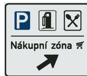
Obrázek 3 - Příklad barevnosti provozních a jiných informativních značek
