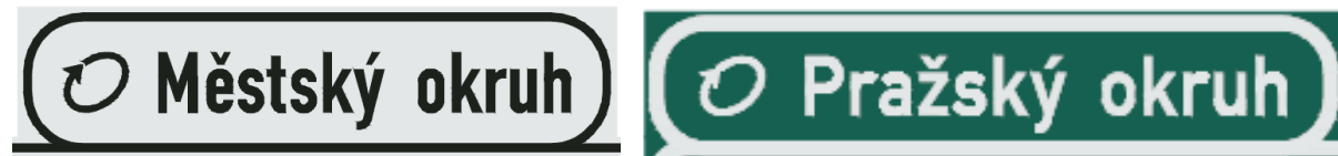
Obrázek 6 - Příklad provedení symbolu dopravního okruhu s uvedením jeho názvu jako nástavce na velkoplošném značení
