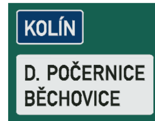
Obrázek 9 - Příklad značení místních cílů bez uvedení názvu hl. m. Prahy
