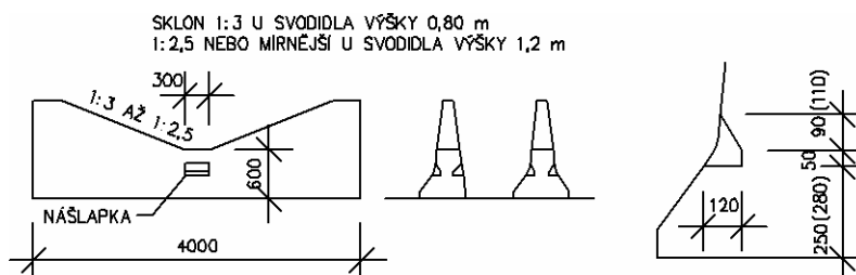
Obrázek 18 - Průchozí díl betonového svodidla
